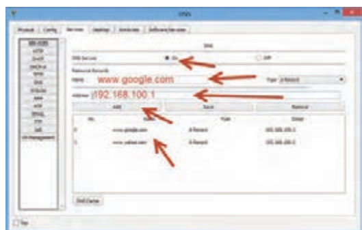
شکل ۴۰ – تنظیمات DNS Server
