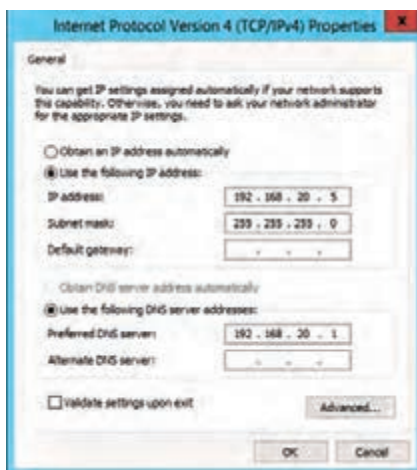
شکل ۴۳- تنظیم آدرس سرور DNS برای سرویس گیرنده
