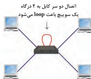
شکل ۵۹- وجود loop در سوییچ
