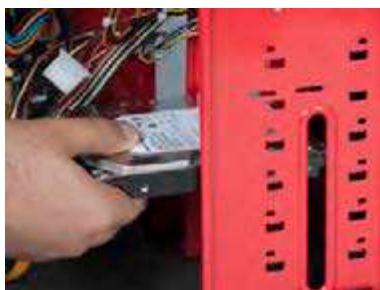
شکل ۴۸- محل نصب دیسک سخت
