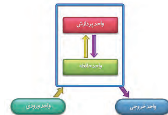
شکل ۱- نمودار سخت‌افزاری سیستم رایانه‌ای
