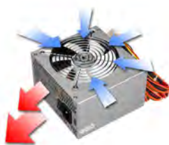
شکل ۲۳- جهت تهویه هوا در منبع تغذیه
