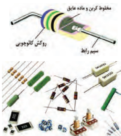
شکل ۵-۱۵ انواع مقاومت ثابت
