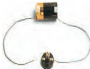
شکل ۵-۸ قطع شدگی در مدار
