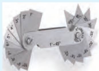
شابلون زاویه (اندازه‌گیری زاویه قطعات)
