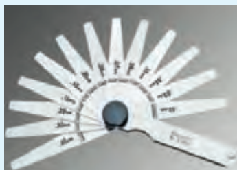
شابلون فیلر (اندازه‌گیری شکاف‌ها و شیارها)
