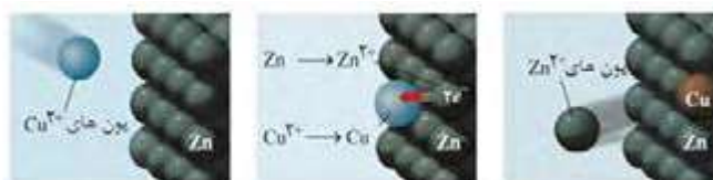
شکل ۳. چگونگی انتقال الکترون از اتم‌های روی به یون‌های مس
