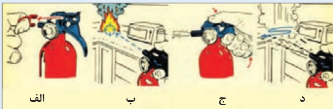
■ شکل ۲۳-۴- روش فعال کردن کپسول آتش‌نشانی (PASS)
